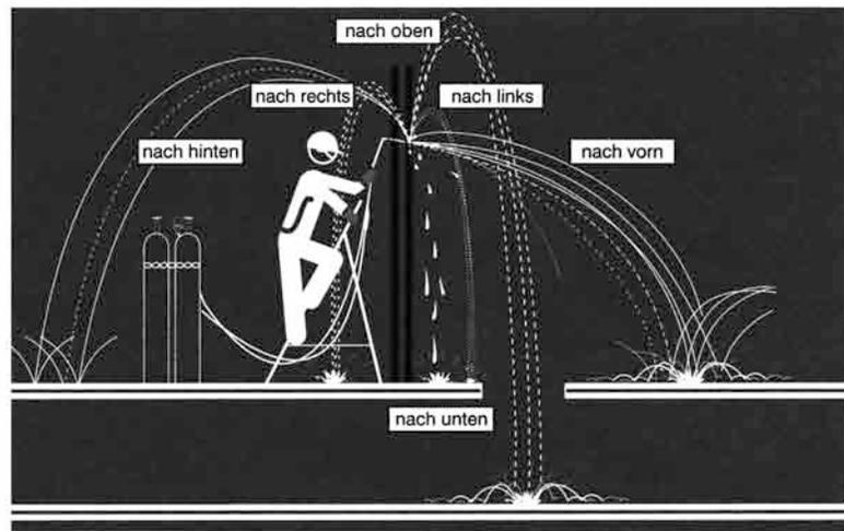
**Bild 1:** Ausbreitungsverhalten heißer Partikel bei schweißtechnischen Arbeiten
