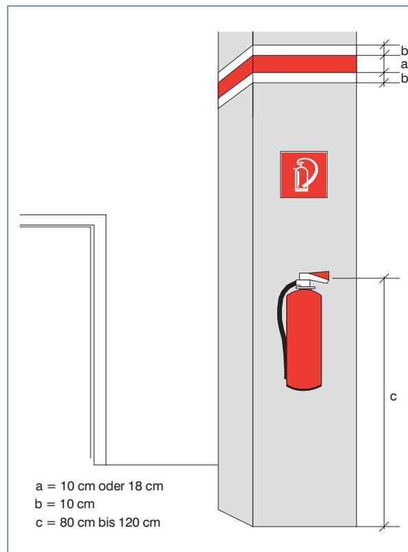
**Abbildung 1:** Montage von Feuerlöschern und Kennzeichnung von Feuerlöscherstandorten
